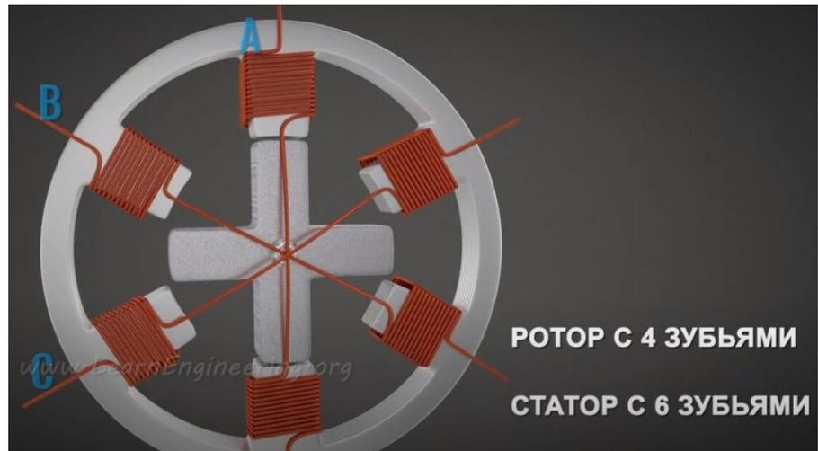
Рисунок 6.1. Ротор и статор двигателя с переменным магнитным сопротивлением.[3]
